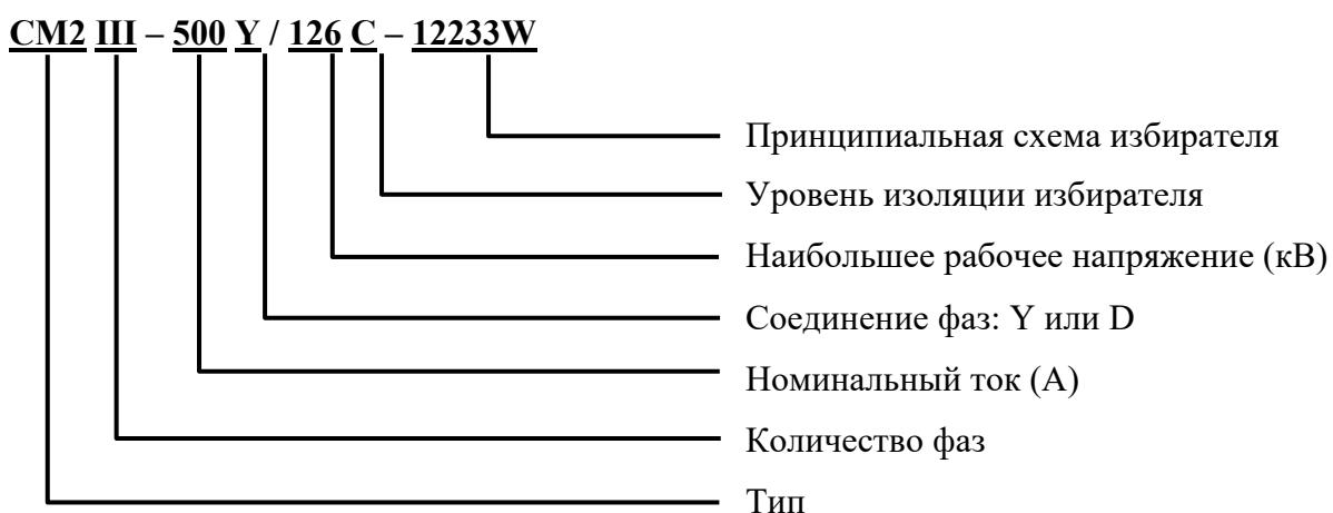
Рисунок 3 Структура условного обозначения устройства РПН
