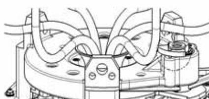
Рисунок 11 Удаление стопорного штифта
